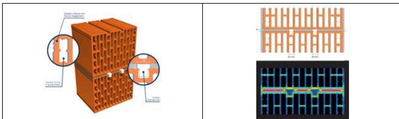
Fig. 4.1.1 Configurazione dei blocchi Modulo e termografia dello stesso.
